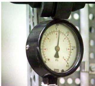
Mycket jämn tryckhållning – manometernålen rör sig knappast alls under drift.
